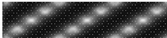
Рис.1. Плотность заряда, индуцированная на поверхности НТ типа зигзаг [7,0] под действием потенциала фосфатных групп ДНК, обернутой вокруг НТ (градация от серого к белому/черному соответствует возрастанию положительного/отрицательного заряда). Показаны три элементарных ячейки в развертке на плоскость
