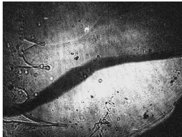
Рис. 1. Двукратная высокоскоростная фотография динамической доменной границы с движущимися вдоль нее уединенными изгибными волнами с резкими передними и затянутыми задними фронтами. Задержка между двумя световыми импульсами 10 нс. Доменная граница движется сверху вниз. На первом положении видны две уединенные изгибные волны, движущиеся в разные стороны. На втором положении видна отраженная уединенная изгибная волна, движущаяся в противоположном направлении падающей волны
