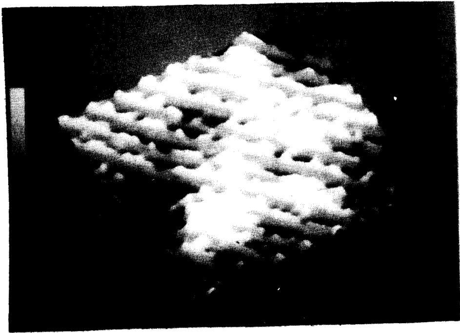
FIG. 3. Crystal lattice of palladium ( X : 42.6 Å. Y : 40.8 Å. Z : 0.7 Å).
