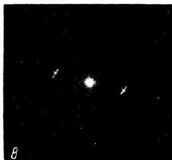
Рис. 2. a - k_t — проекция вектора отраженной волны, u_{\pm} — два противоположных направления перемещения пятна, пунктиром указана кинематика образования вырожденной решетки q_3 ; b — рефлексы от решетки q_2 , \delta — рефлексы от решетки q_1
