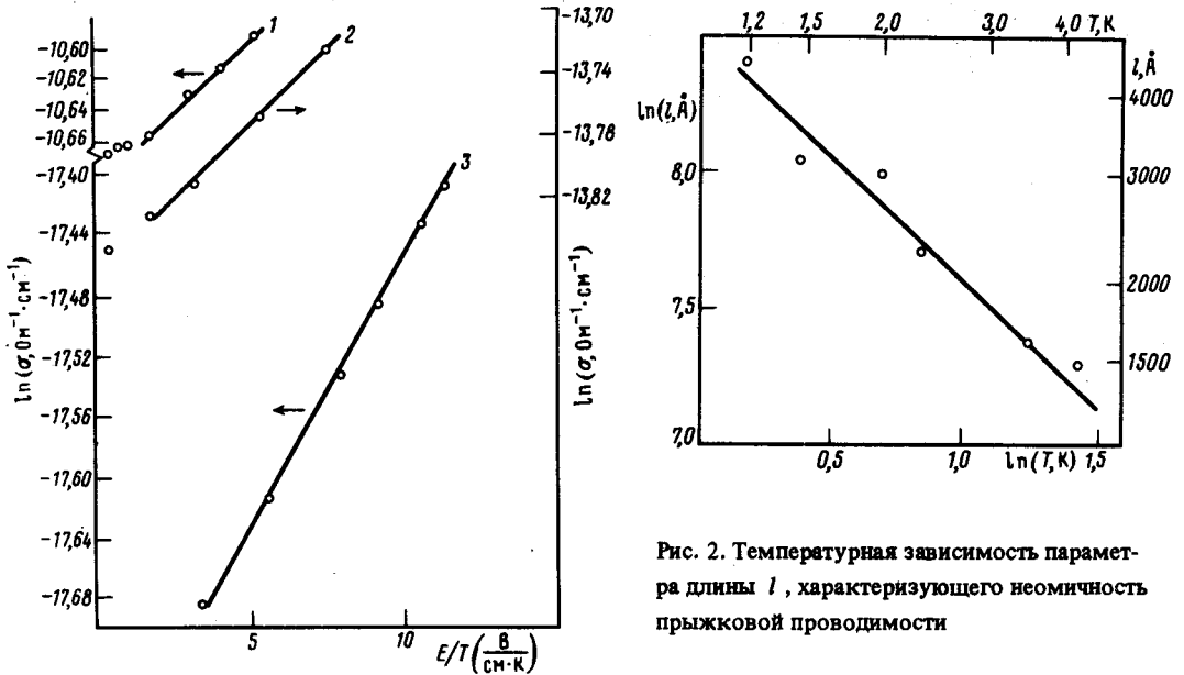
Рис. 1. Зависимость проводимости одного из исследованных образцов от электрического поля при разных температурах — T , К: 1 — 4,23; 2 — 2,99; 3 — 1,99
