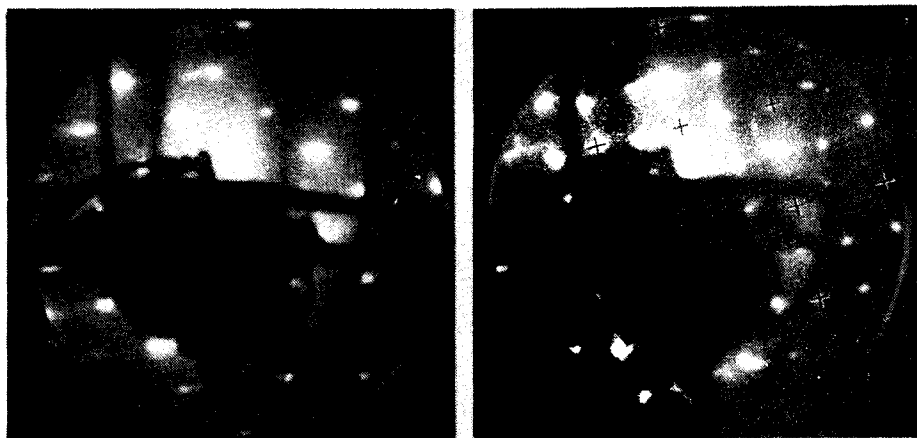
Рис. 2. Дифракция медленных электронов на поверхности EuTe (100): а — T = 15 К, б — T \sim 8 К (крестами отмечено несколько сверхрефлексов)
