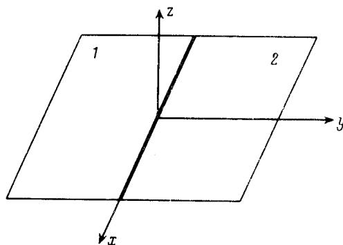
В настоящей работе мы покажем, что для туннельных переходов, образованных тонкими сверхпроводящими пленками (СП) ( $d \ll \lambda_L$ ), связь тока  $j$  с разностью фаз  $\varphi$  носит нелокальный характер. Это обуславливает степенной характер спадания магнитного поля и тока вихря на больших расстояниях от его центра.
