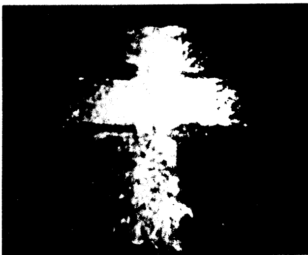
Рис. 2. Образец пространственной структуры сечения пучка фиолетового излучения при пространственной модуляции пучка ИК излучения
