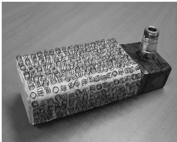
Рис.2. Фото исследуемой антенны
