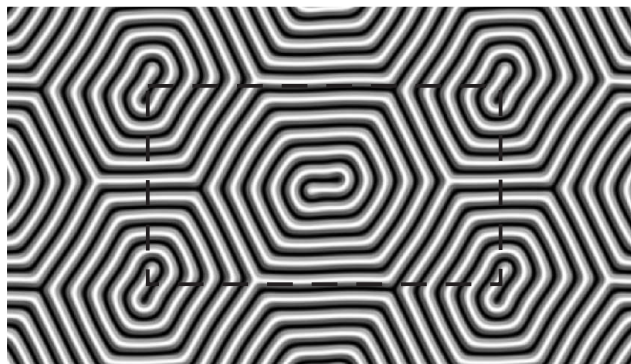
Рис. 4. Найденная структура РАС с пятью витками в нулевом поле. Выделенный сектор – фактическая область расчетов, которая является элементарной ячейкой
