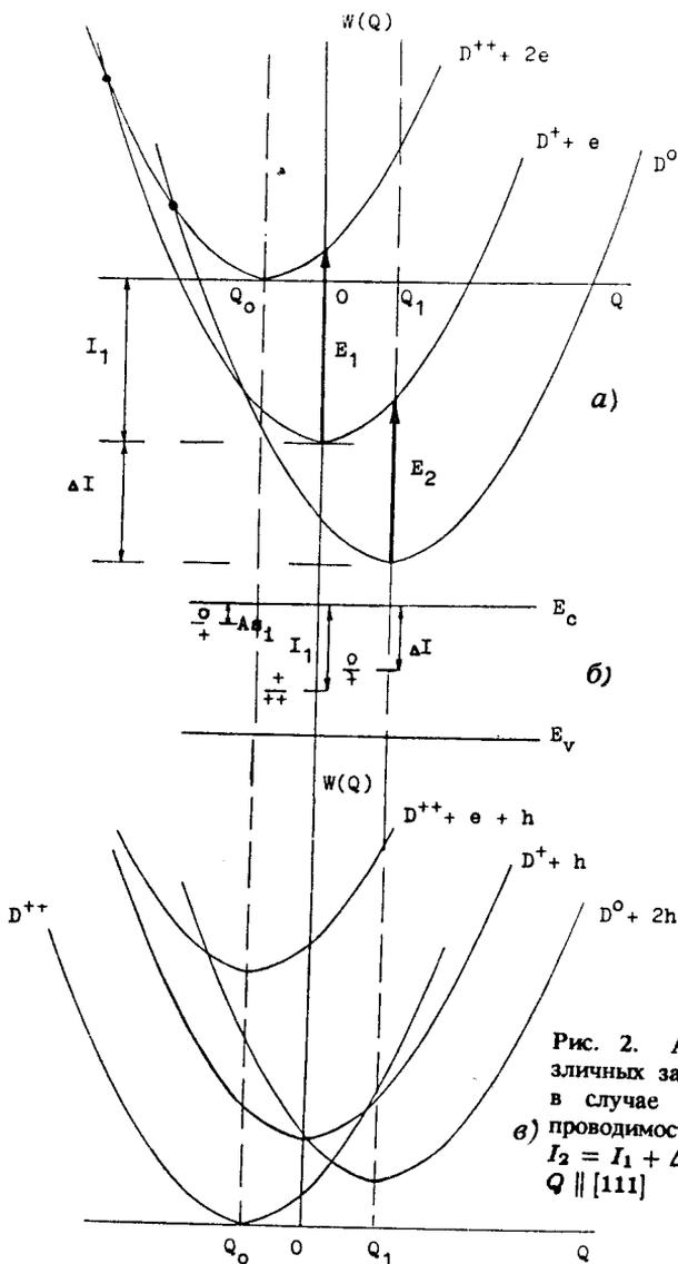
Рис. 2. Адиабатические потенциалы (а, в) различных зарядовых состояний  $EL2$ -центра в GaAs в случае оптических переходов дефект - зона (а) проводимости (а) и валентная зона-дефект (в);  $I_2 = I_1 + \Delta I$ ; (б) - эквивалентная зонная схема;  $Q \parallel [111]$
