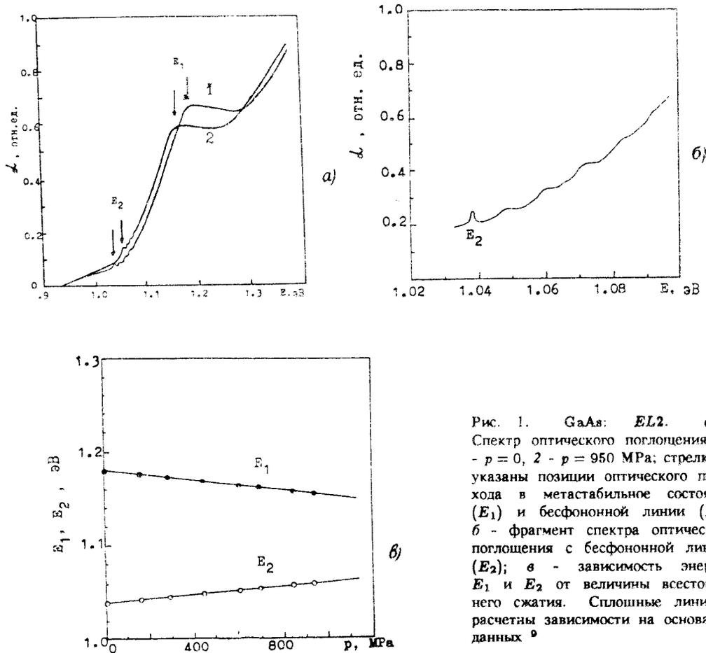
Рис. 1. GaAs: EL2. а - Спектр оптического поглощения: 1 -  $p = 0$ , 2 -  $p = 950$  МПа; стрелками указаны позиции оптического перехода в метастабильное состояние ( $E_1$ ) и бесфононной линии ( $E_2$ ); б - фрагмент спектра оптического поглощения с бесфононной линией ( $E_2$ ); в - зависимость энергий  $E_1$  и  $E_2$  от величины всестороннего сжатия. Сплошные линии - расчетны зависимости на основании данных <sup>9</sup>
