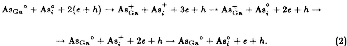
Подобная сверхбыстрая рекомбинация неравновесных носителей может быть причиной тушения фотоемкости, фотопроводимости и ЭПР-спектров в GaAs с  $EL2$ -центрами <sup>4-6</sup>. Адекватной проверкой модели метастабильности  $EL2$ -центра GaAs явилось с одной стороны, обнаружение оптической регенерации  $D^+$ -состояния при  $h\nu = E_g - E_1$  (рис.2б) <sup>11</sup>:
