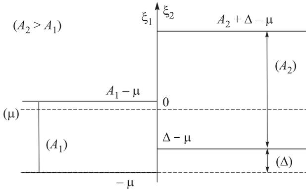
Рис. 1. Схема двух энергетических зон электронов:  $\xi_{1(2)}$  – энергия электронов 1-й (2-й) зоны, отсчитанная от химического потенциала  $\mu$ ;  $A_{1(2)}$  – ширина 1-й (2-й) зоны;  $\Delta$  – расстояние (по энергии) между дном 2-й и 1-й зон
