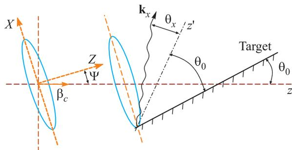
Рис. 2. (Цветной онлайн) Схема генерации когерентного переходного излучения наклонным эллипсоидальным сгустком
