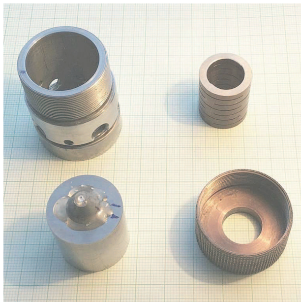
Рис. 1. (Цветной онлайн) Детали камеры высокого давления с алмазными наковальнями для измерения рамановских и мессбауэровских спектров
