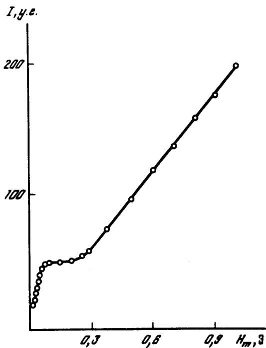
Рис. 1. Зависимость интенсивности сигнала поглощения I кристаллического ПА от амплитуды модулирующего поля H_m
