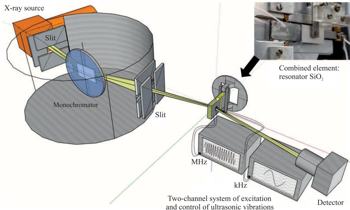
Рис. 1. (Цветной онлайн) Рентгенооптическая схема экспериментальной установки
