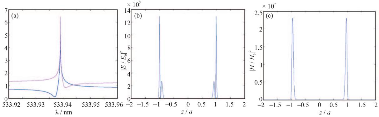
Рис. 2. (Цветной онлайн) Структура Фано резонанса (а) на  $\lambda = 533.939$  нм для частицы с параметром размера  $q = 70.60$ . Синия линия – интенсивность электрического поля, красная – магнитного (в логарифмическом масштабе). Пики интенсивностей электрического (b) и магнитного (c) полей. Соответствующие максимальные значения равны  $1.287 \cdot 10^6$  и  $2.302 \cdot 10^7$ . Распределения (b), (c) построены вдоль диаметра сферы в линейном масштабе
