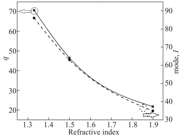
Рис. 3. Зависимость параметра размера  $q$  диэлектрической сферы и резонансной моды от показателя преломления материала частицы в области генерации максимальных магнитных и электрических полей порядка  $10^6-10^7$
