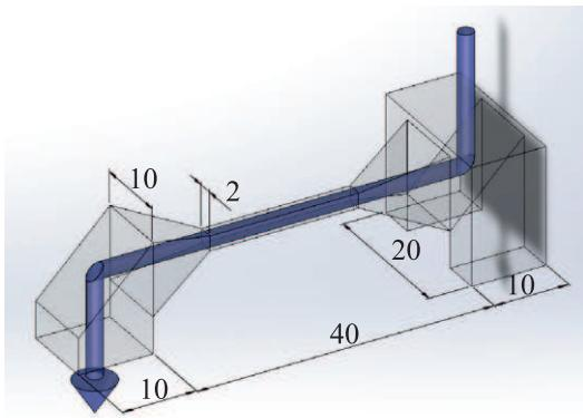
Рис. 3. (Цветной онлайн) Трехмерная модель волновода с призменными адаптерами заведения/выведения излучения, размеры структуры приведены в микрометрах, синим цветом показан ход лазерного излучения. Высота структуры 16 мкм
