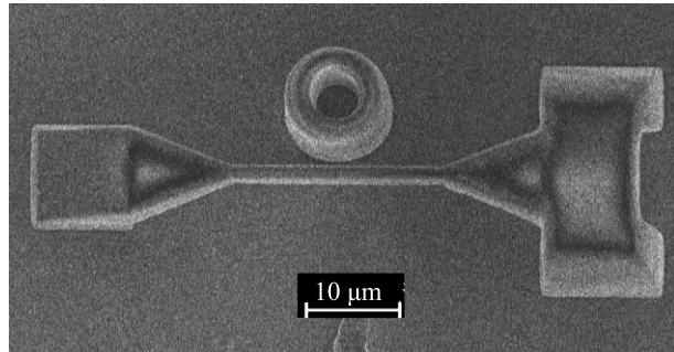
Рис. 5. СЭМ изображение волновода, расположенного на высоте 10 мкм над подложкой, с призменной системой заведения/выведения излучения, и полого цилиндра с диаметром 10 мкм, внешняя боковая поверхность которого отстоит от волновода на 1 мкм. Скорость печати 500 мкм/с
