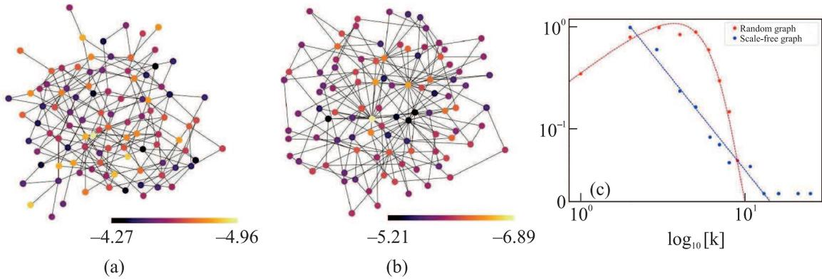
Рис. 1. (Цветной онлайн) Интерфейс среды случайного лазера в виде: (а) – случайной ( $k_{\max} = 9$ ,  $k_{\min} = 1$ ) и (б) – безмасштабной ( $k_{\max} = 25$ ,  $k_{\min} = 2$ ) сети при  $N = 100$ ;  $k_{\max}/\min$  – максимальное/минимальное значение степеней узлов. Цветовые панели характеризуют собственные значения матрицы смежности  $\tau_{ij}$ . (с) – Распределение степеней узлов соответствующих сетей в двойном логарифмическом масштабе. Остальные детали приведены в тексте
