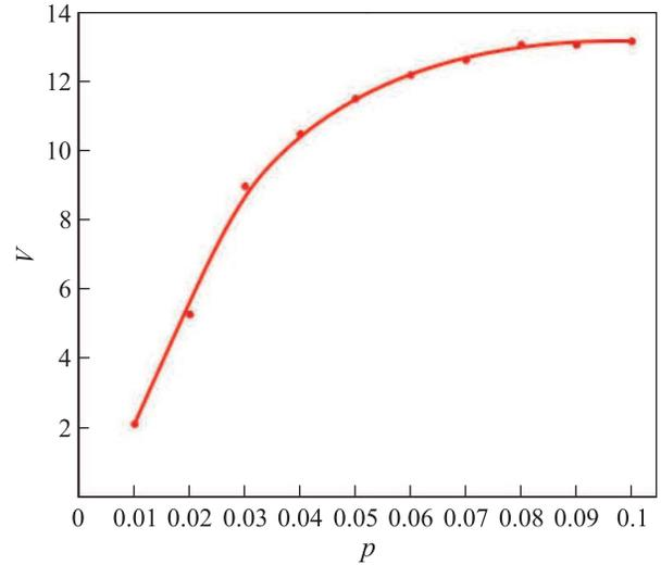
Рис. 4. (Цветной онлайн) Усредненная по большому числу реализаций случайных графов зависимость среднего объема мод  $V$  СЛ от вероятности  $\mathbf{p}$  (точкам соответствуют численно полученные зависимости, а сплошная линия – результат их аппроксимации). Остальные параметры те же, что и на рис. 2
