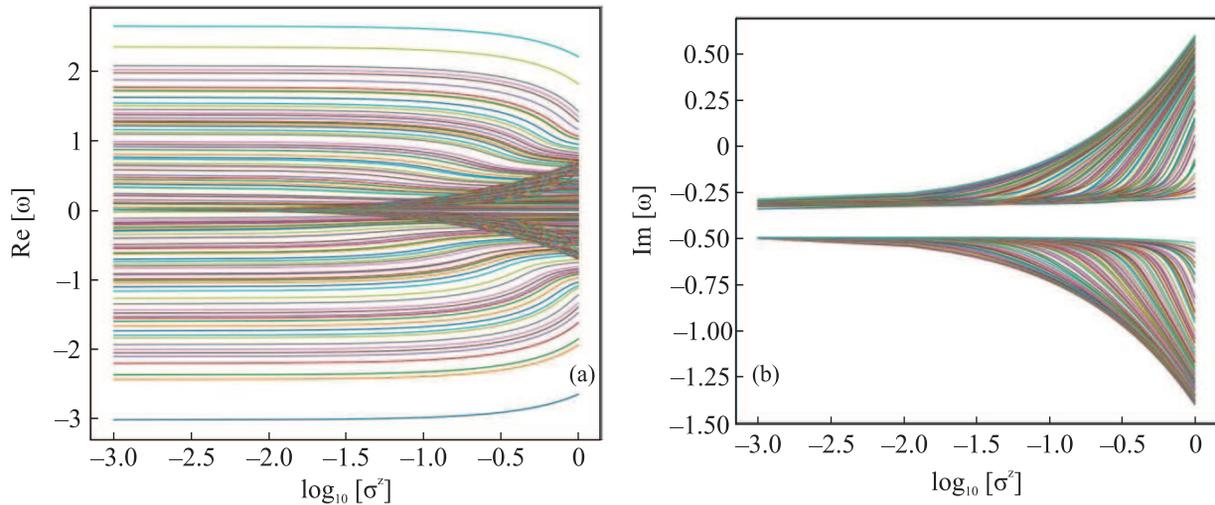
Рис. 3. (Цветной онлайн) Зависимость (а) – действительной  $\text{Re}[\omega]$  и (б) – мнимой,  $\text{Im}[\omega]$ , частей собственных частот СЛ, представляющего собой случайный граф, как функции десятичного логарифма разности населенностей  $\sigma^z$ . Остальные параметры те же, что и на рис. 2
