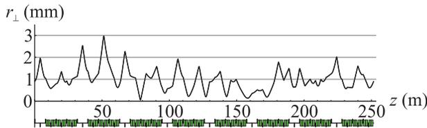
Рис. 5. (Цветной онлайн) Отклонение искаженной замкнутой орбиты, вызванное ошибками выставки квадруполей
