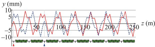
Рис. 2. (Цветной онлайн) Искривление замкнутой орбиты при стабилизации радиальной и продольной поляризации при  $\gamma G = 7$
