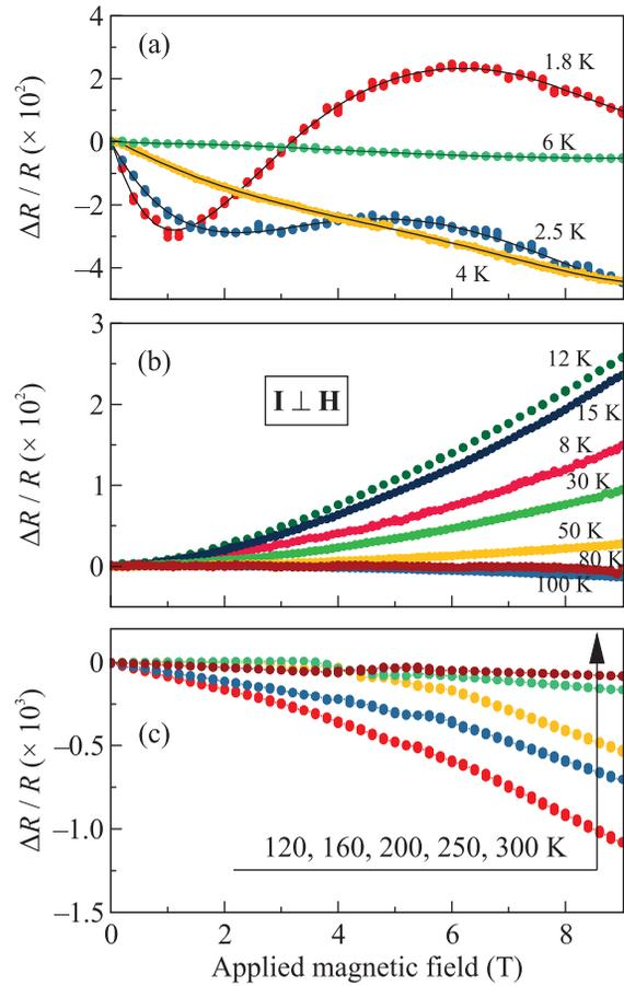
Рис. 4. (Цветной онлайн) Магнетосопротивление FeSi как функция температуры и поперечного магнитного поля ( $\mathbf{I} \perp \mathbf{H}$ ,  $\mathbf{I} \parallel [100]$  для всех панелей). Изменен масштаб  $\Delta R/R$  на панели (c)
