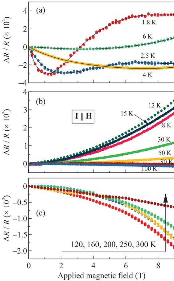
Рис. 3. (Цветной онлайн) Магнетосопротивление FeSi как функция температуры и продольного магнитного поля ( $\mathbf{I} \parallel \mathbf{H}$ ,  $\mathbf{I} \parallel [100]$  для всех панелей). Изменен масштаб  $\Delta R/R$  на панели (c)
