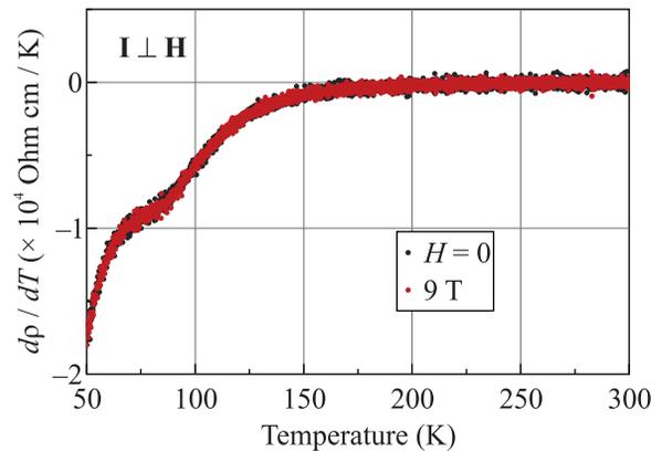
Рис. 7. (Цветной онлайн) Производная удельного сопротивления FeSi в нулевом магнитном поле и при 9 Тл,  $I \perp H$ . То же самое наблюдается в параллельной ориентации. Заметим, что FeSi находится на грани металлического состояния при 180–200 K
