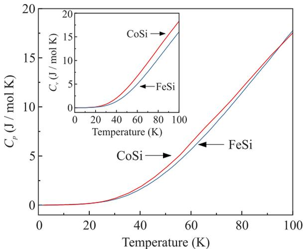
Рис. 1. (Цветной онлайн) Зависимость теплоемкости  $C_p$  от температуры FeSi (настоящие измерения) и CoSi [15]. На вставке показаны теоретически рассчитанная фононная теплоемкость FeSi и CoSi [15]
