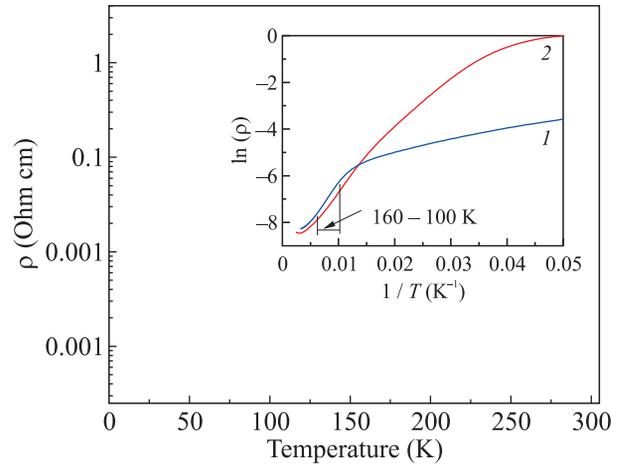
Рис. 2. (Цветной онлайн) Удельное сопротивление  $\rho$  FeSi как функция температуры. На вставке две линии демонстрируют поведение удельного сопротивления образцов 1 и 2 в координатах  $\ln(\rho)$  и  $T^{-1}$ . 1 – объемный образец FeSi, 2 – нитевидный образец FeSi [13]
