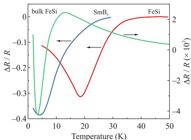
Рис. 8. (Цветной онлайн) Сравнение MR ( $\Delta R/R = (R_{9T} - R_{0T})/R_{0T}$ ) FeSi и SmB<sub>6</sub> в зависимости от температуры в магнитном поле  $B = 9$  Тл из работы [14]. Данные настоящей работы в объемном образце FeSi также представлены на графике. Отметим, что MR объемного FeSi на порядок меньше MR нитевидного [14]. Размеры образцов в обоих случаях существенно различаются: мкм и мм в нитевидных и объемных образцах соответственно
