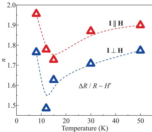
Рис. 6. (Цветной онлайн) Значения показателя степени  $n$  в формуле  $\Delta R/R \sim H^n$ , описывающего кривые MR на рис. 3 и 4 при  $T > 6\text{ K}$
