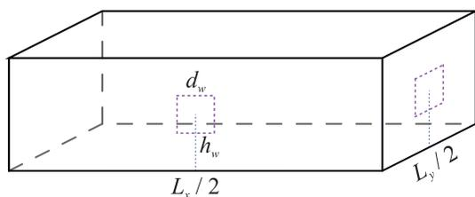
Рис. 1. (Цветной онлайн) Вытянутая материальная ловушка для УХН размером  $L_x \times L_y \times L_z$ . Отмечены квадратные отверстия (переднее и торцевое) размера  $d_w$ , расположенные на высоте  $h_w$ , через которые нейтроны вылетают из ловушки
