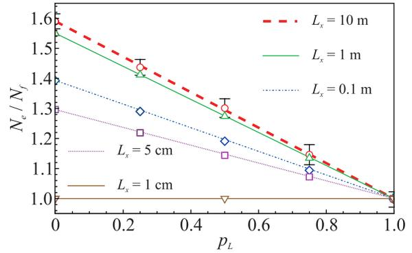
Рис. 2. (Цветной онлайн) Отношение количества нейтронов, прошедших через торцевое отверстие  $N_e$  к количеству нейтронов, прошедших через переднее отверстие  $N_f$  как функция вероятности ламбертовского рассеяния  $p_L$ , для ловушек различной длины  $L_x$ . Для  $L_x = 10$  м показано стандартное отклонение при усреднении по 10 симуляциям из  $10^4$  нейтронов
