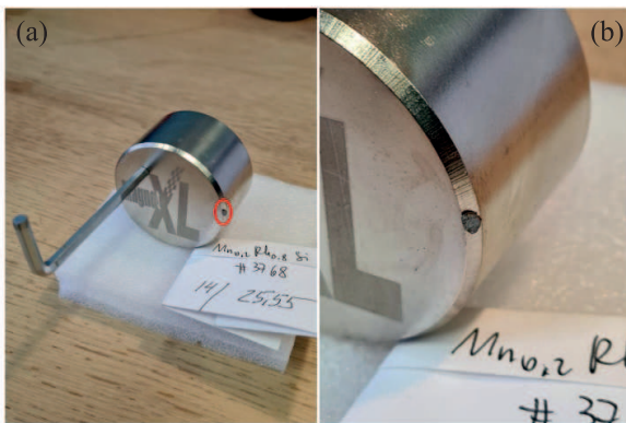
Рис. 7. (Цветной онлайн) Образец Mn_{0.2}Rh_{0.8}Si , удерживаемый постоянным магнитом при комнатной температуре. (а) – Общий вид магнита с образцом (образец отмечен красным кружком). (б) – увеличенное изображение
