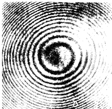
Рис. 1. а - схема эксперимента: 1 - He-Ne-лазер; 2 - расширитель пучка; 3 - делитель пучка; 4,5 - зеркала; 6 - объектив; 7 - жгут волокон; 8 - рассеивающая линза; 9 - полупрозрачное зеркало; 10 - фотокамера; 11 - экран для наблюдения интерференции пучков. б - картина интерференции опорной сферической волны и волны с винтовой дислокацией волнового фронта
