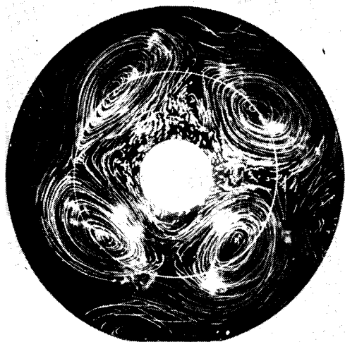
Рис. 2. Возбуждение четвертой моды неустойчивости Кельвина – Гельмгольца. Линия "разрыва" скорости течений проходит через центры вихрей
