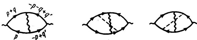
В работе<sup>3</sup> был указан вид диаграмм, обусловливающих существенную перенормировку коэффициента диффузии для  $d = 1, 2$ . Они показаны на рис. 1<sup>3-5</sup>. Здесь волнистая линия представляет собой диффузон в электрон-электронном канале, где его функция Грина сохраняет обычный вид
