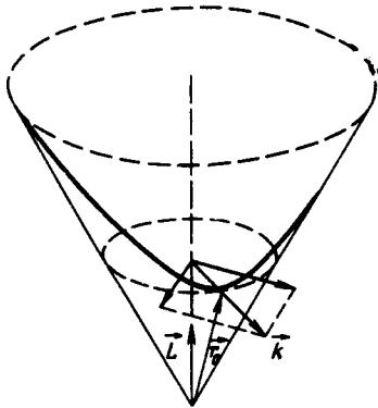
Траектория заряженной классической бессpinовой частицы в поле магнитного монополя, расположенная на конусе  $\mathbf{L} \mathbf{r} = qr \mathbf{r}_0$  – вектор из вершины конуса в ближайшую точку траектории. Вектора  $\mathbf{K}$ ,  $\mathbf{e}_1$ ,  $\mathbf{e}_2$  ортогональны осям конуса, параллельны вектору момента  $\mathbf{L}$ ,  $\mathbf{e}_1^2 = \mathbf{e}_2^2 = L^2 - q^2$
