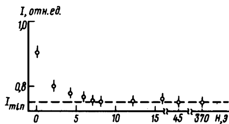
Рис. 1. Зависимость интенсивности дифрагировавшего мессбауэровского излучения при частичной расстройке резонанса (на 5 естественных ширин мессбауэровской линии) от величины напряженности магнитного поля ( \alpha = 27^\circ )
