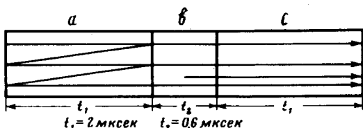
Рис. 1. Схема прохождения акустических импульсов через образец (б); а, с, — передающий и приемный пьезопреобразователи
