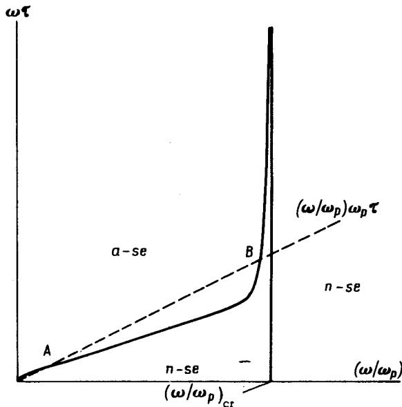
Схема расположения областей нормального скин-эффекта  $n-se$  и аномального скин-эффекта  $a-se$ . Сплошная кривая представляет зависимость  $\omega\tau$  от  $(\omega/\omega_p)$  и разграничивает области  $n-se$  и  $a-se$ ; она имеет вертикальную касательную в начале координат
