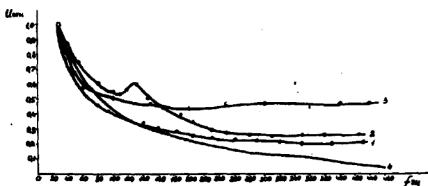
Рис. 2. Частотные кривые модуляции света: 1 – модуляция при освещении снизу, 2 – модуляция при освещении сверху, 3 – электромеханическая модуляция, 4 – частотная характеристика газонаполненного болометра
