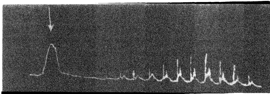
Рис. 3. Осциллограмма входного импульса сложной формы (указан стрелкой) и выходных импульсов (период 19 нсек)
