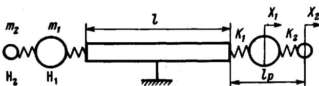
механического усилителя резонансных колебаний (как показано ниже) может быть использована система с двумя степенями свободы. Схема такого детектора показана на рисунке.
