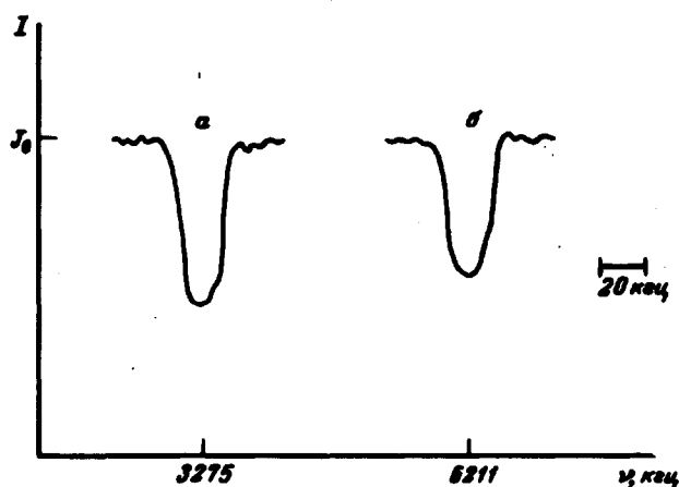
Рис. 2. Сигналы АЯМР Al^{27} : а — для перехода 1^{1/2} \leftrightarrow 3/2 , б — для перехода 1^{1/2} \leftrightarrow 5/2
