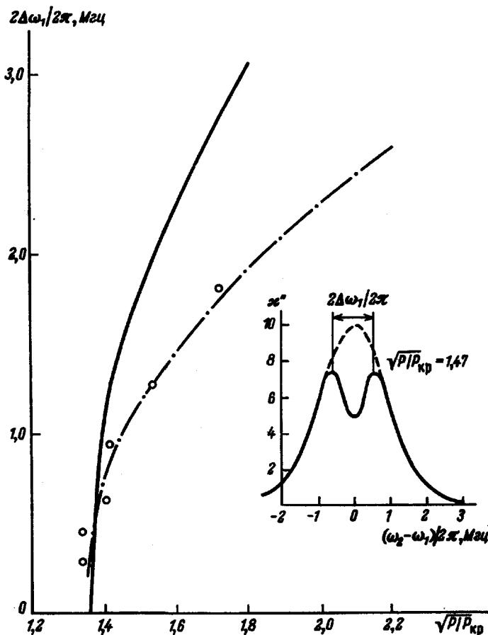
Экспериментально на частоте 2000 МГц исследовался ДФМР на монокристаллической сфере диаметром 3 мм, изготовленной из иттрий-галлиевого граната ( $4\pi M_0 = 1100$  Гс). Источником насыщающего излучения служил генератор Г4-8, детектирующее поле создавалось генератором Г3-22. Линейная перестройка частоты детектирующего излучения производилась специальным устройством. Девиация частоты в пределах линий ФМР не приводила к существенным изменениям уровня детектирующего излучения.
