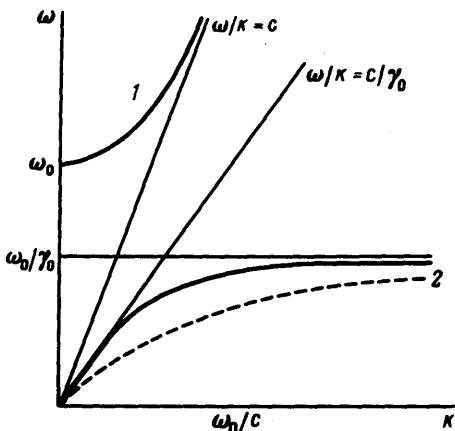
Дисперсионные зависимости  $\omega(k)$  для волн в азимутальном, электронном пучке, сплошные кривые относятся к случаю малых амплитуд ( $\lambda \rightarrow 1$ ), пунктиром показан случай максимально возможных амплитуд, определяемых формулой (7)
