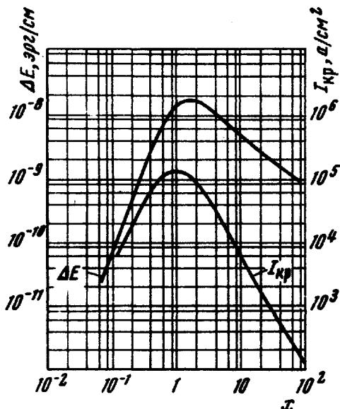
Если для оценки силы пининга воспользоваться приближением  $F = \Delta E/d$ , то для плотности критического тока, при максимальной энергии связи, получим  $J_{cr} \approx 10^5 a/\text{см}^2$ . На рисунке приведена также зависимость плотности критического тока от безразмерного параметра  $x$ .
