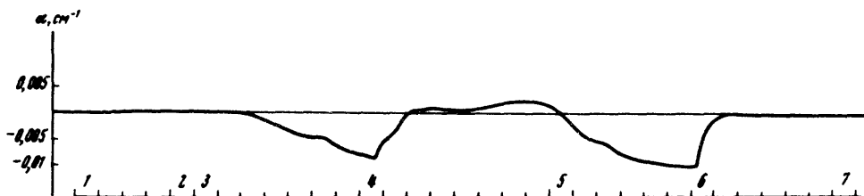
Рис. 1. Временная запись коэффициента усиления-поглощения в сверхзвуковом потоке газа. Метки времени (нижняя шкала) следуют через 15 \text{ сек}
