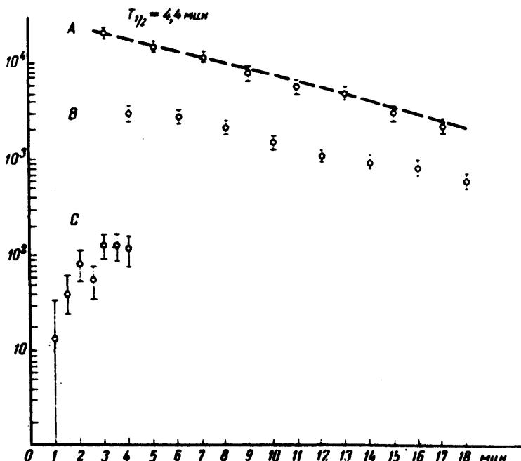
Изменение интенсивности линии 148 кэв  $^{92}\text{Tc}$  во времени: А – в технециевой фракции, В, С – в рутениевой фракции. Время, приведенное по оси абсцисс, отсчитывается с момента окончания химического выделения соответствующей фракции
