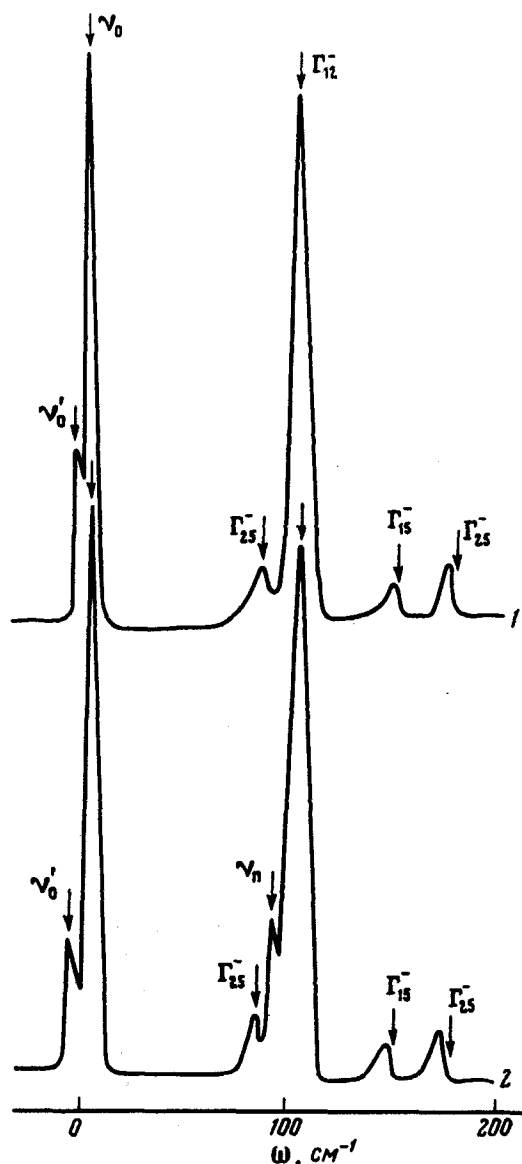
Микрофотограммы спектров люминесценции монокристалла \text{Cu}_2\text{O} при давлении: 1 - P \approx 7 \text{ кг/мм}^2 , 2 - P \approx 10 \text{ кг/мм}^2 , \nu_0 и \nu_0' обозначены линии ортоэкситона, \nu_{\text{п}} - линия параэкситона. Частота фононов \omega отсчитывается от несмещенного положения уровня ортоэкситона. T = 1,8^\circ\text{K} , P \parallel C_4
