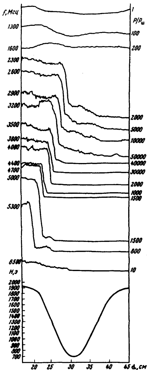
Рис. 2. Распределение интенсивности колебаний вдоль системы в зеркальной ловушке с пробочным отношением R = 2,8 , I = 60 ма, U = 1,5 кэв, P = 7 \cdot 10^{-5} мм рт.ст. Кривая 1 — ионный ток насыщения
