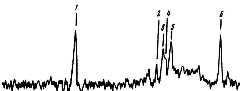
Микрофотограмма спектра излучения лазера на COS, полученного на спектрографе ИСП-51 с помощью ЭОП: 1 – реперная линия  $\lambda = 1,014 \text{ мк}$  (лазер ЛГ-126), 2 + 5 спектр лазера на COS ( $2 - 1,0920 \text{ мк}; 3 - 1,0975 \text{ мк}; 4 - 1,100 \text{ мк}; 5 - 1,1055 \text{ мк}$ ), 6 – реперная линия  $\lambda = 1,1523 \text{ мк}$  (рутная лампа ПРК-4)
