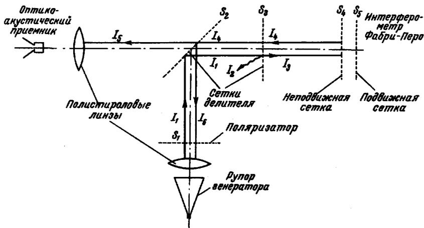
Схема интерферометра Фабри-Перо, работающего на отраженном сигнале.
