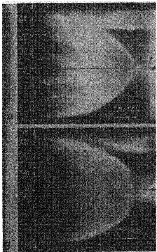
Щелевые развертки свечения разряда, снятые через горизонтальную щель на расстояние 1,5 см над поверхностью анода: *a* — для разряда в чистом дейтерии, *b* — для разряда в смеси дейтерия с ксеноном
