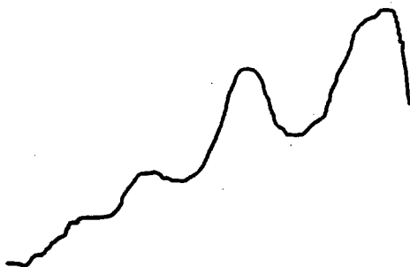
Рис.1. Зависимость прозрачности пленки алюминия от толщины при температуре 4,2^\circ\text{К} . По горизонтальной оси отложено изменение толщины пленки, по вертикальной — интенсивность прошедшего света (в произвольных единицах)
