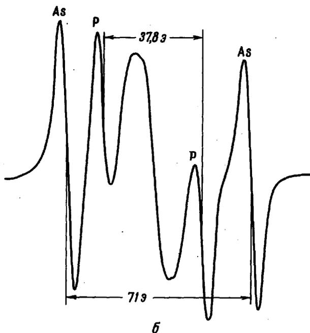
Спектры ЭПР  $d\chi''/dH = f(H)$  двух сильнокомпенсированных образцов кремния  $n$ -типа:  $a - N_D = 2 \cdot 10^{17} \text{ см}^{-3}$ ,  $K = 0,9$  и  $б - N_D = 7,2 \cdot 10^{17} \text{ см}^{-3}$ ,  $K = 0,99$ . Две крайние линии на спектрах — линии сверхтонкого расщепления эталонного образца  $n - \text{Si}$  с  $6 \cdot 10^{16} \text{ ат. As/см}^3$
