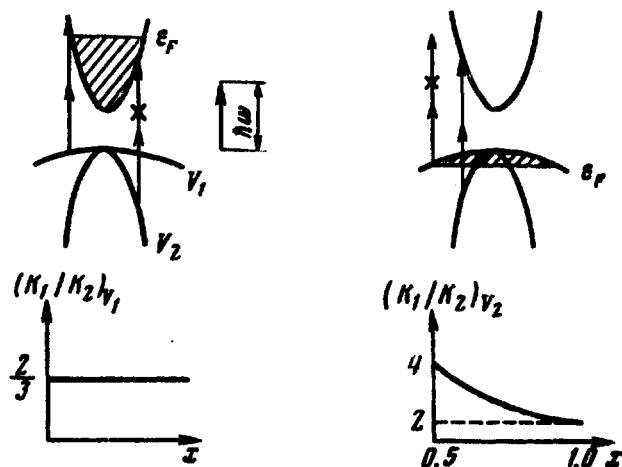
Схема возможных двухфотонных переходов в образцах антимонида индия:  $a - n = 6,2 \cdot 10^{17} \text{ см}^{-3}$ ,  $b - p_o = 1,1 \cdot 10^{18} \text{ см}^{-3}$ ,  $\lambda = 9,5 \text{ мкм}$ ;  $b - p_o = 1,1 \cdot 10^{18} \text{ см}^{-3}$ ,  $\lambda = 10,6 \text{ мкм}$ ,  $T = 77^\circ\text{K}$
