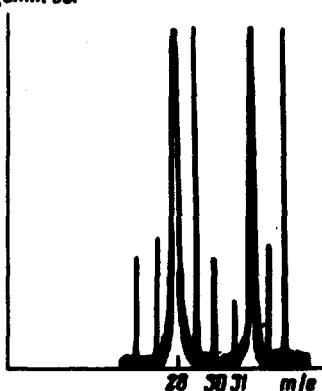
В настоящей работе получено разделение изотопов азота в лазерно-стимулированной реакции  $N_2 + O_2 \rightarrow 2NO$ . Реакция требует энергии активации не менее 3,3 эв [3], и при низкой "поступательной" температуре газа продукты реакции должны, согласно (1), обогащаться изо-
