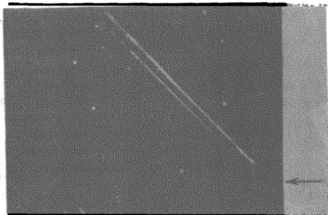
Рис. 1. Полосы генерации в CdS при температуре T = 80^\circ K . Стрелкой указано приложения импульсного напряжения. Длина двойной полосы составляет 0,8 см.
