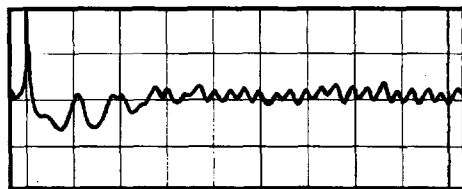
Рис.2. Магнитоакустические колебания в пластине толщиной 0.96 мм. Развертка 500 нс/дел
